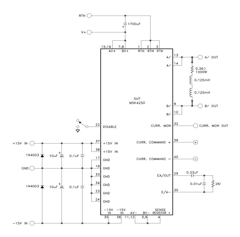
TYPICAL TEST SCHEMATIC
