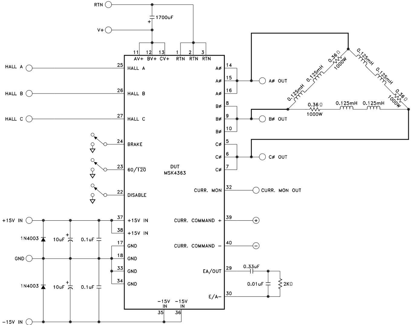
TYPICAL TEST SCHEMATIC
