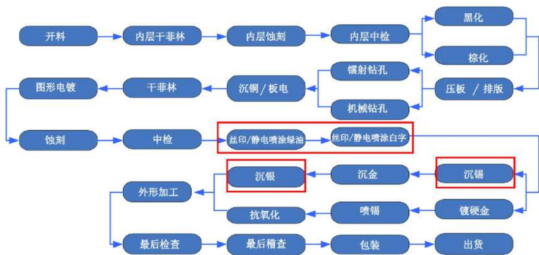
图 3.4-4 PCB 线路板生产工艺（2007 年至今）
