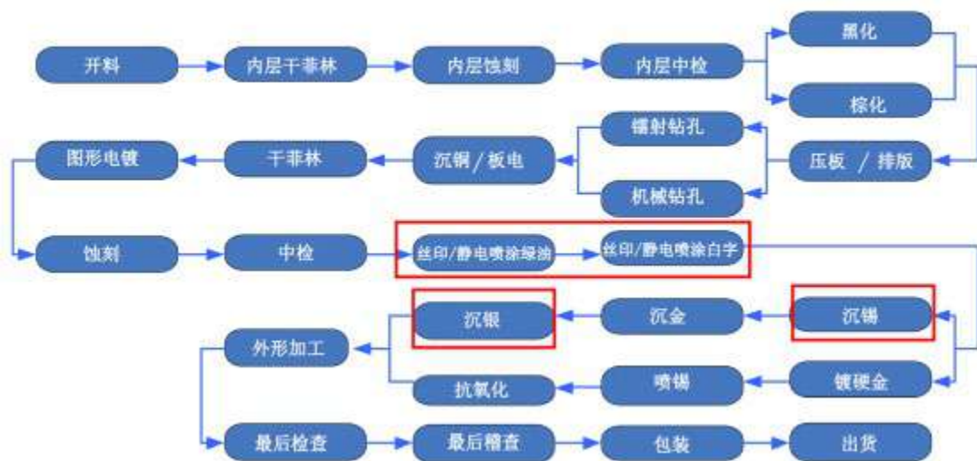
图 2.4-5 PCB 线路板生产工艺（2007 年至今）
