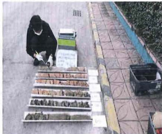
照片4 S4 土壤柱状图
