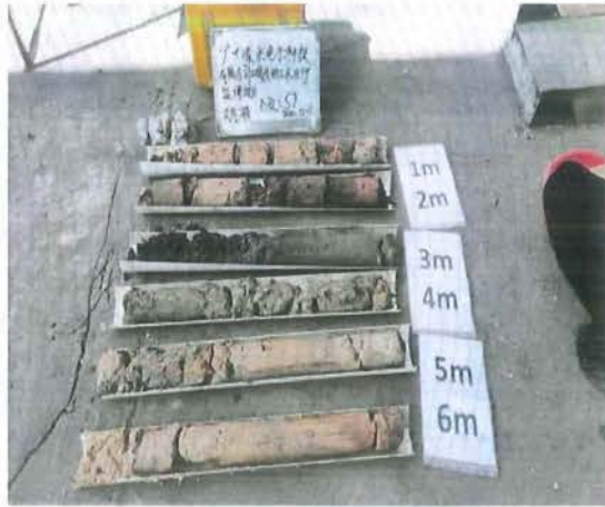
照片7 S7 土壤柱状图
