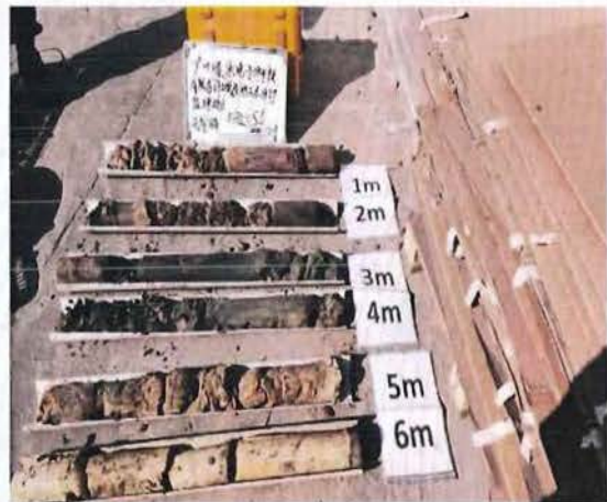
照片6 S6 土壤柱状图
